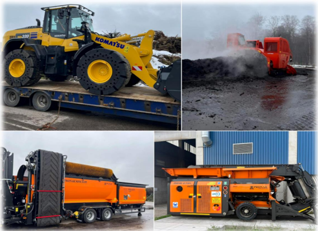
1 pav. Įsigyta įranga kompostavimo procesui užtikrinti (pirma nuotrauka iš kairės - ratinis frontalinis krautuvas, antra iš dešinės-savaeigis komposto vartytuvas, trečia - mobilus būgninis sijotuvus, ketvirta nuotrauka - lėtaeigis atliekų smulkinuvas)
